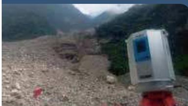
地面滑坡是危害比较大的自然灾害之一，而要获得全面而精确的滑坡数据，并用于对滑坡进行勘查与监测、预报则更为困难。HS系列扫描仪三维扫描可以测量到精确的点位移，实施三维整体监测。观测滑坡体整体部特征点，采集面状点数据，能够很好的对滑坡做好勘查、监测工作。
